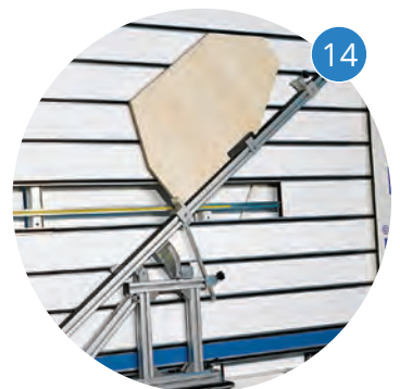
Dispositivo taglio inclinato Dispositif pour coupe d'angle
