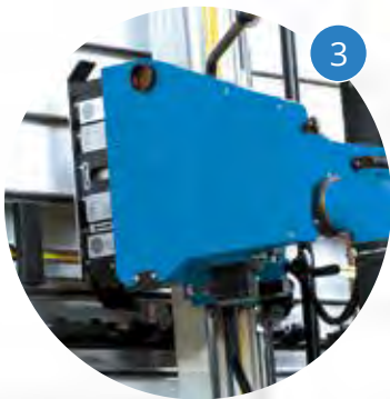
Testa con incisore rotativo Tete avec inciseur lame
