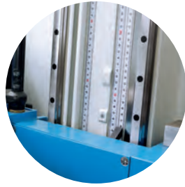
Linear guides Dos guías prismáticas
