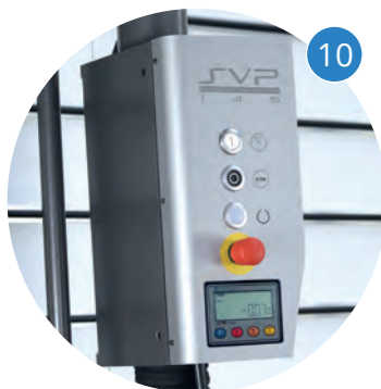
Electronic horizontal measuring display Medidor digital para posición horizontal
