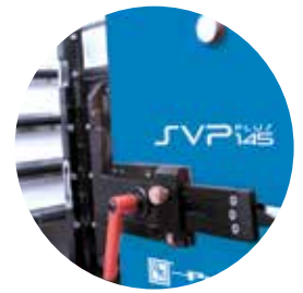
Adjustable thickness stop Tope de profundidad
